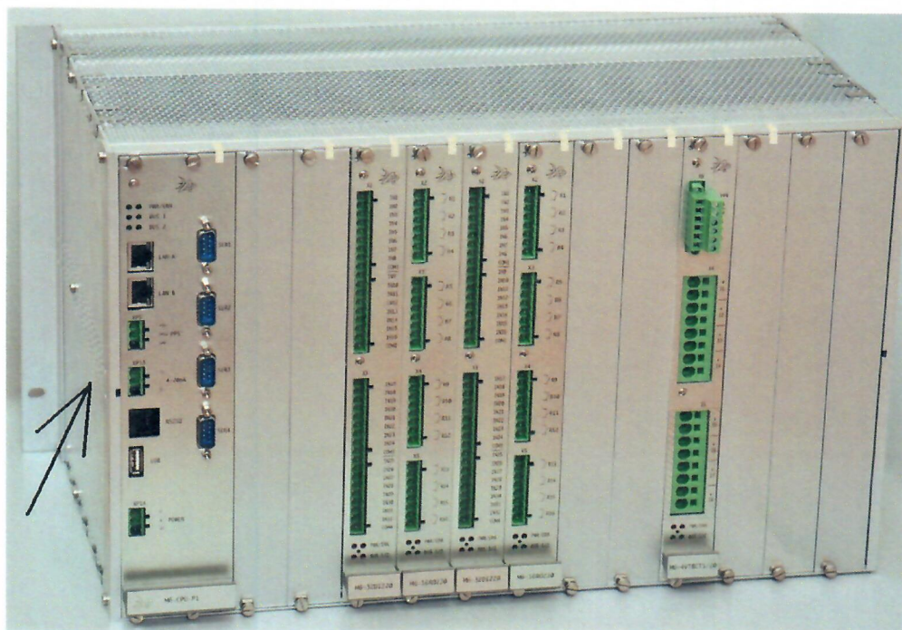
Рисунок 2 - Внешний вид контроллера на 14 слотов (вид со стороны установки модулей, в зависимости от кода заказа внешний вид контроллера может изменяться). Стрелкой показано место нанесения знака утверждения типа
