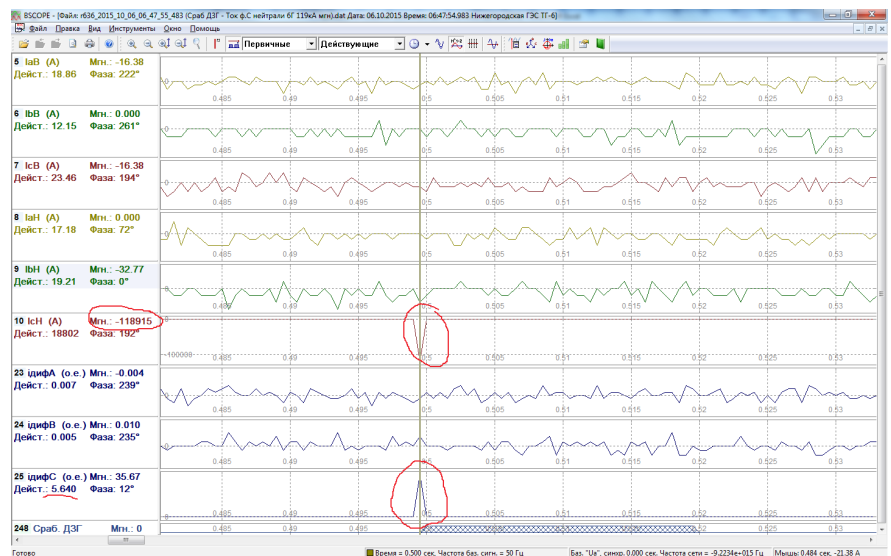
Рис. 4. Осциллограмма срабатывания терминала РЗА при ложном выбросе тока фазы С (зафиксировано терминалом TOP 300 ДЗБ)
